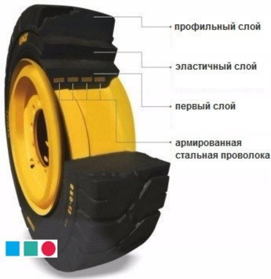
Затем идет слой - смесь чрезвычайно эластичная и обеспечивает эффект пружины и комфорт езды.
