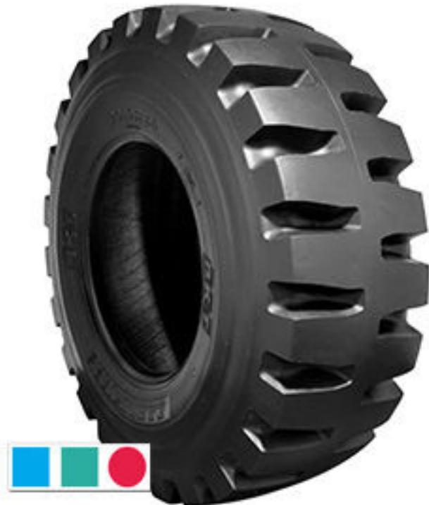
EARTHMAX SR 53 — это радиальные шины с цельным металлокордом, специально разработанные для погрузчиков или бульдозеров, которые работают в сложных условиях разработки каменных карьеров, включая подземные разработки.
